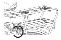
Schieben Sie den Akku entlang der Akkuschiene so weit wie möglich in den Akkuhalter.
